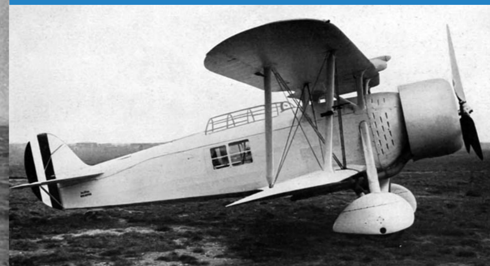
■ Italský dálkový průzkumný letoun Romeo Ro-37bis. I u tohoto letadla je dvoučlenná osádka chráněna kabinou z průhledného materiálu. Okno v postranní stěně trupu, na obrázku zřetelně patrné, umožňuje pozorovateli dobrý výhled. Při nejvyšší rychlosti 305 km/h má toto letadlo dolet 1200 km.
